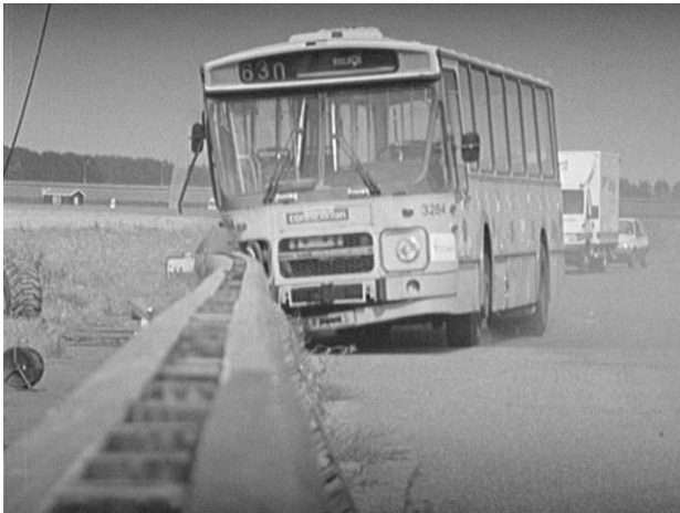
Abbildung 7: Full-scale Testlauf der Holzleitplanken
