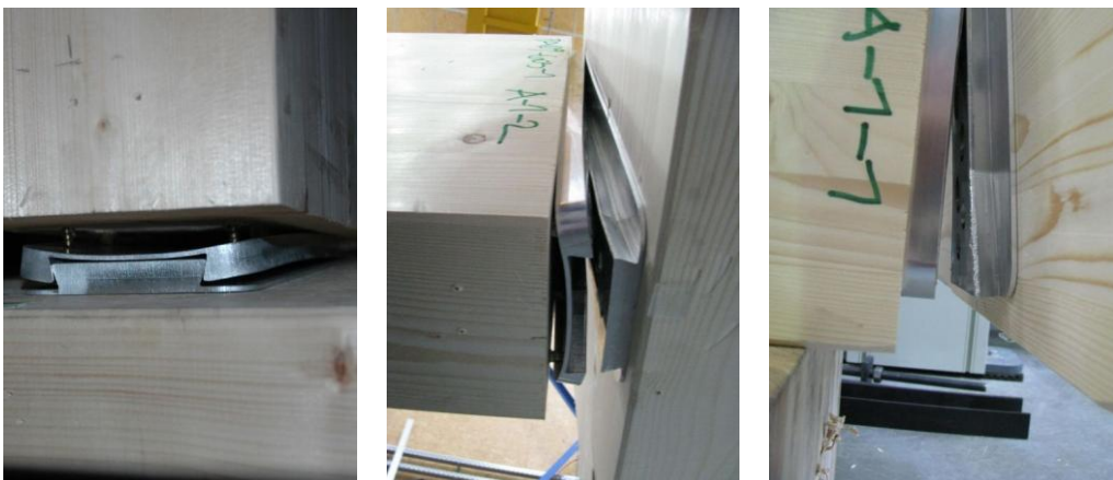
Abbildung 13: Bruchbilder – Beanspruchungsart 1; Ausziehen der MomS im NT und Aufwölbung des „nut“-förmigen Teils (Vorversuche) (li.); wie vorher, jedoch Ausziehen des unteren, schwalbenschwanzförmigen Teils des Verbinders (Mitte); Detail des vorherigen Bildes(re.)
