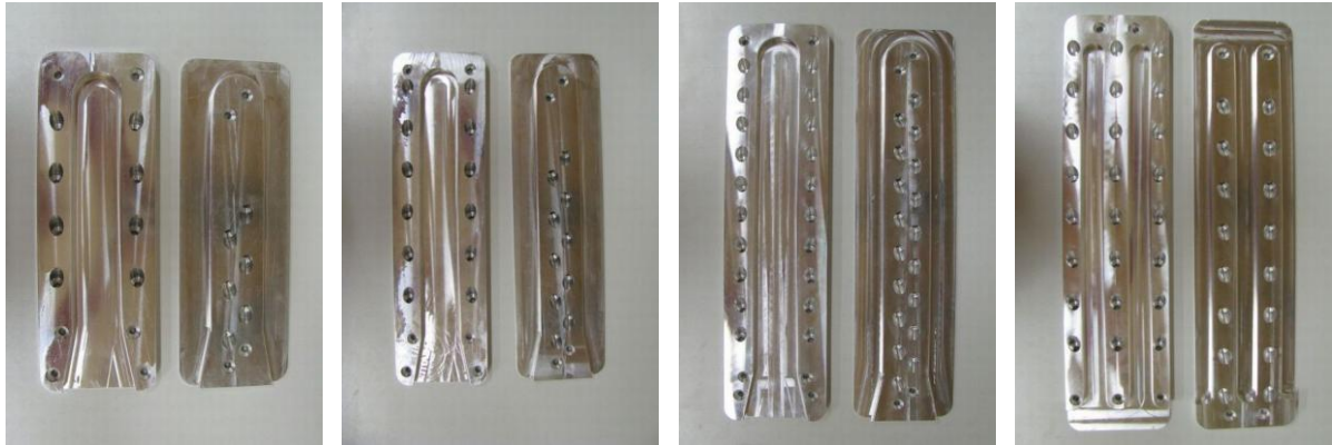
Abbildung 8: Im Zuge der Zulassungsprüfungen untersuchte Verbindertypen (v.l.n.r.: Sherpa-XL-80; -XL-140; -XL-250; -XLD-220)
