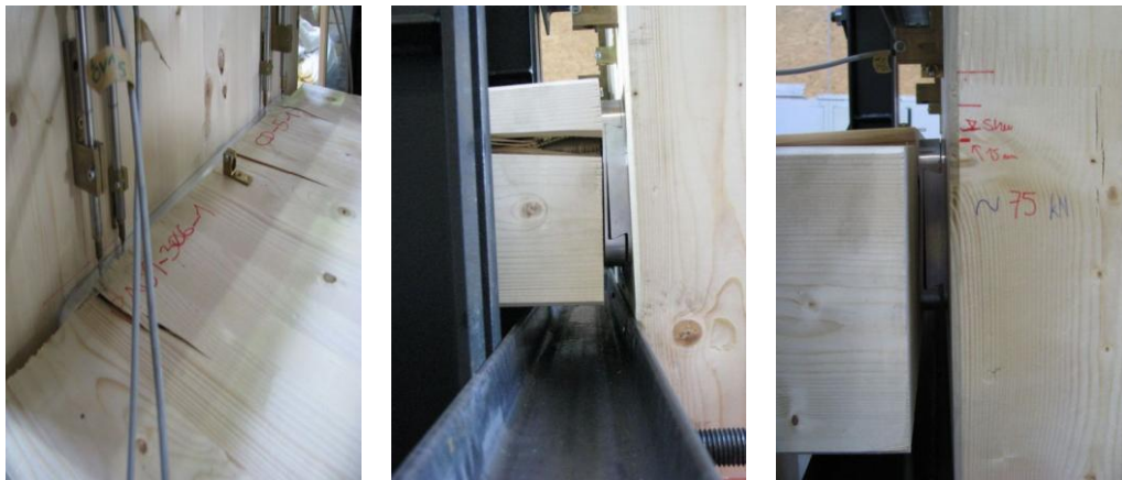
Abbildung 15: Bruchbilder – Beanspruchungsart 5; Rissbildung und Abscheren von plattenförmigen Holzteilen im Bereich der oberen Schraubenreihe (li.); seitliche Rissbildung im Bereich der oberen Schraubenreihe; Fließgelenkbildung mit „Seilwirkung“ der Schrauben (Mitte); Verschiebung des Verbinders infolge der Beanspruchung auf Abscheren und der damit verbundenen Rissbildung (re.)
