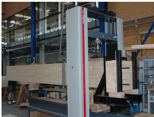
Abbildung 7: Skizze zu den gemessenen Weggrößen (li.) und Bild der verwendeten Prüfkongfiguration (re.)
