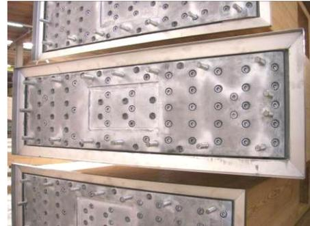
Abbildung 10: Angespaxte Stahlplatte mit Blecheinfassung
