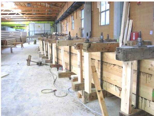
Abbildung 15: Blockverklebung der Bögen
