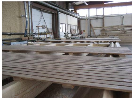
Abbildung 20: Elementfertigung Bekleidung
