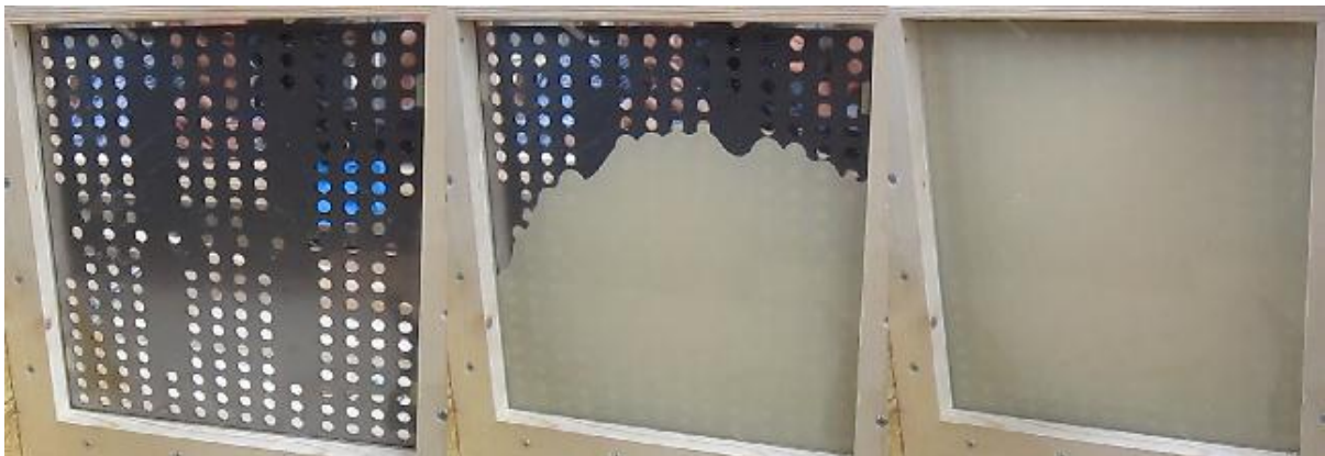
Abbildung 2: Laborversuch zur Visualisierung des Klebstoff-Fließverhaltens bei der Lochblechverklebung
