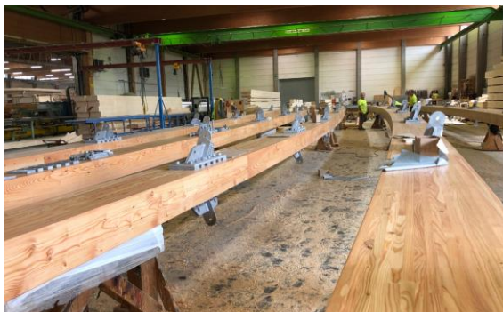
Abbildung 5: Vormontage Innenturmbinder im Werk in Kleinheubach
