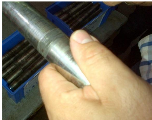
Abbildung 9: Last-Verformungskurve des 1. und 7. Kollektives (links); Kerben im Passbolzen (rechts)
