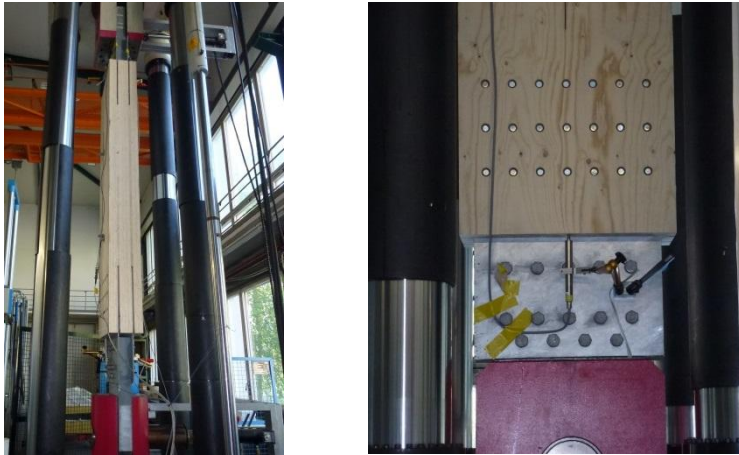
Abbildung 8: Grossmassstäblicher Versuch einer Passbolzenverbindung am KIT
