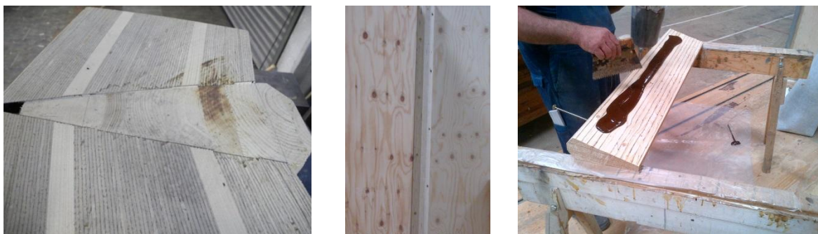
Abbildung 3: Ausbildung des Eckstoßes und Aufbringen des Kleber mit der Zahnpachtel
