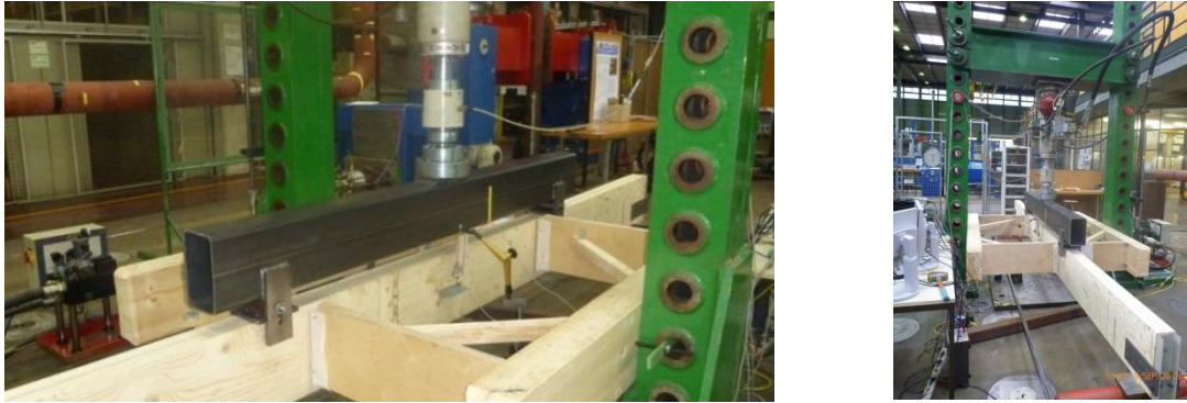
Abbildung 14: Dauerschwingversuch mit Biegebelastung an der MPA Stuttgart
